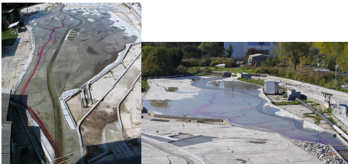
Slika 2. Fizična hidravlična modela območij HE Brežice (levo) in HE Mokrice (desno) zgrajena v distorziranem merilu M_V 1:62,5 in M_H 1:125.
