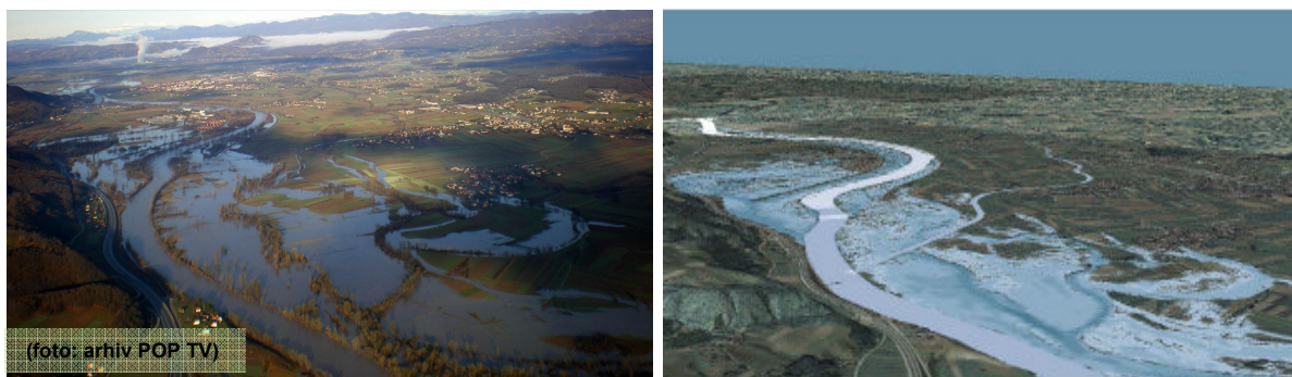
Slika 4. Primerjava območja poplavljenosti Dobovškega polja ob visoki vodi 26.12.2009 in rezultata simulacije istega dogodka s hibridnim modelom
