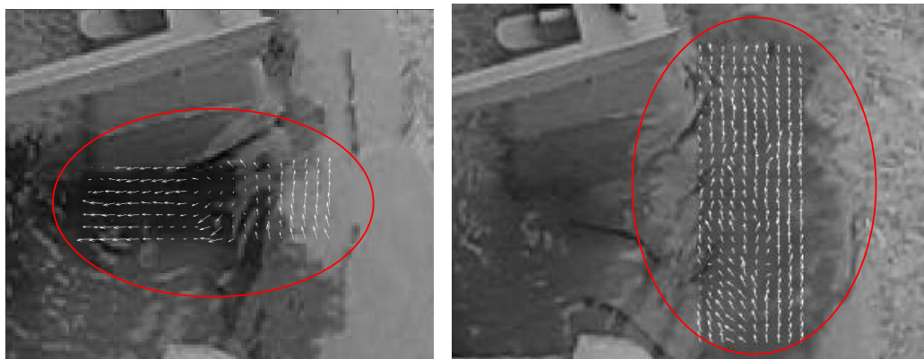
Slika 6: Polje hitrosti na razcepu toka ob gorvodnem stebri: barvilo dozirano na sredini globine toka (slika levo), barvilo dozirano ob dnu modela (slika desno)
