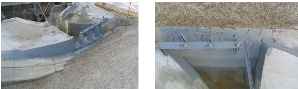
Slika 1: Fizični hidravlični model vtočnega objekta. Na tlorisnem posnetku (desno) so ob stebrih vidne tudi nitke za boljše ponazoritev pretočnih razmer ob dnu modela
